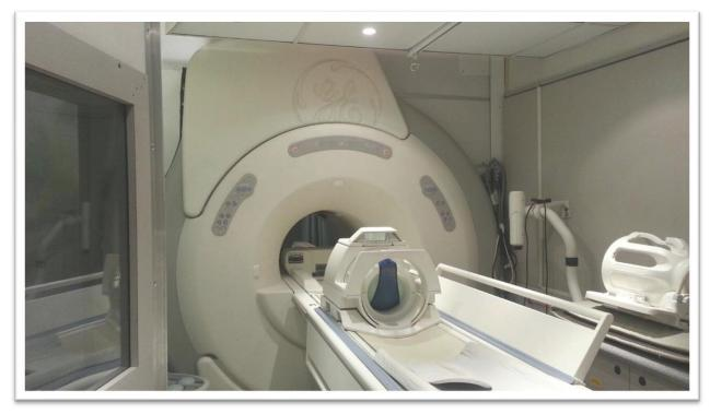
Signa Excite Hdxt è una apparecchiatura da 1,5 Tesla, superconduttiva, a 16 canali indipendenti (32 canali in quadratura), con bobine multielemento. Ciò consente di acquisire il segnale attraverso sedici ricevitori indipendenti in modo da ottimizzare il rapporto segnale rumore nell'imaging ad alta risoluzione.
